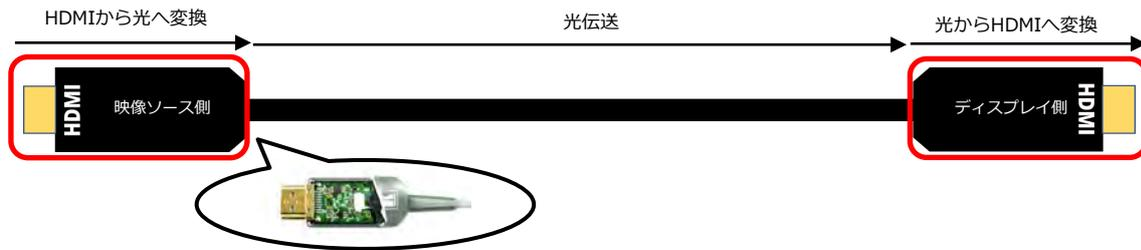
HDMIコネクタ部分(両端)に電子回路が埋め込まれており、この回路が「デジタル信号(HDMI)から光信号・光信号からデジタル信号(HDMI)」への変換を行います。
