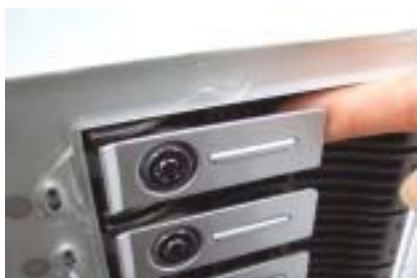
写真5 (指先をトレイレバーの右側手前に掛けます)
